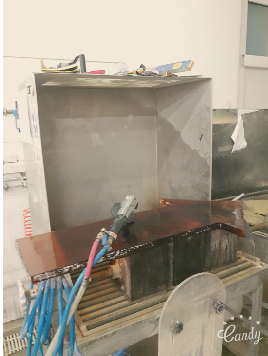
Finisaj aşamasında Havalı Sulu El taşlama makinasıyla
