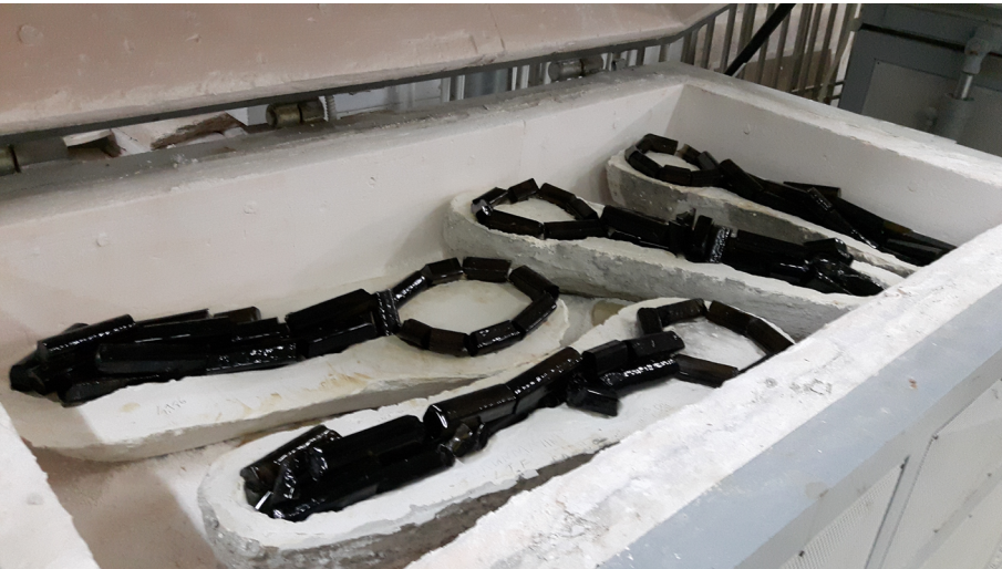
Fırın yakımına hazır, kalıplar ve kalıp içerisine yüklenmiş camlar
