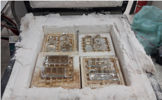
Refrakter kalıplar füzyon fırınında,
